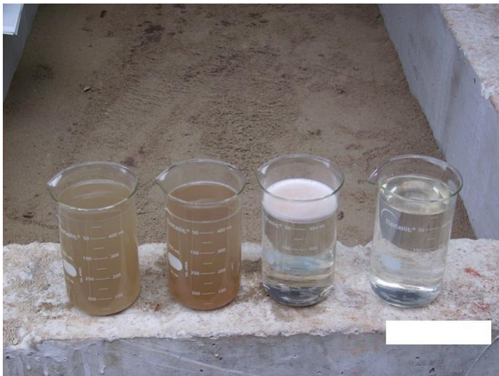
Comparativo do efluente de entrada e saída da estação de tratamento físico-químico
