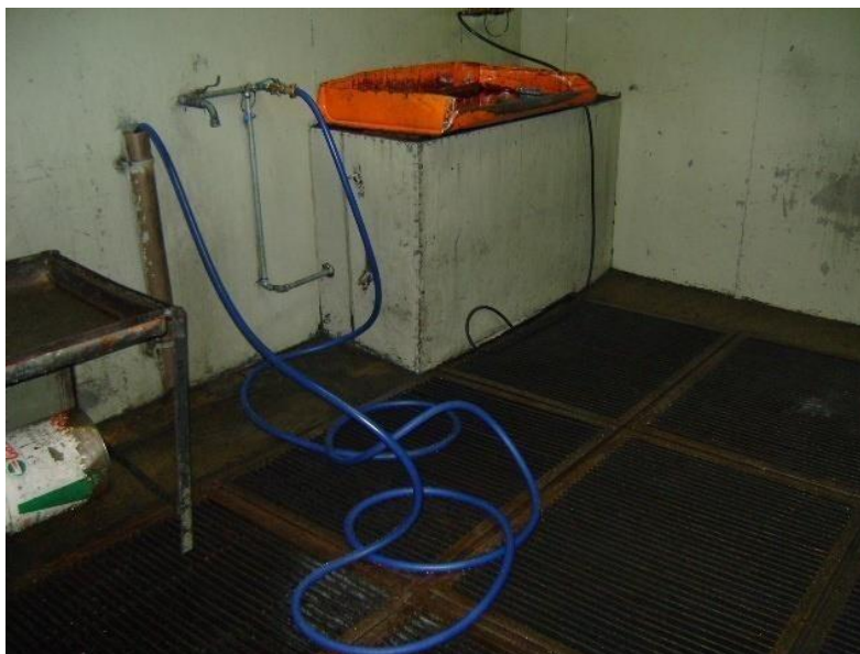
Lavador de peças – piso elevado
