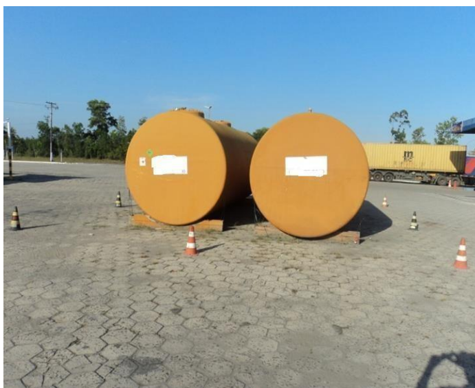
Tanques de parede dupla - Jaquetados
